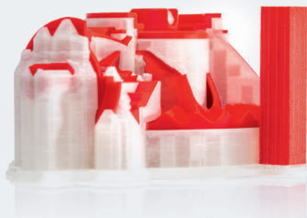
Modèle de mécanisme d'engrenage avant dissolution du matériau de support
