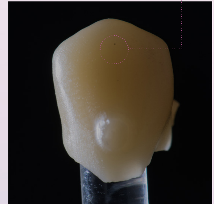
Tâches sombres sur la surface d'une restauration après le fraisage, également dues à une contamination.
