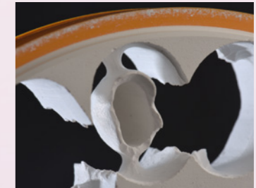
Restauration endommagée lors du retrait de la fraiseuse.
