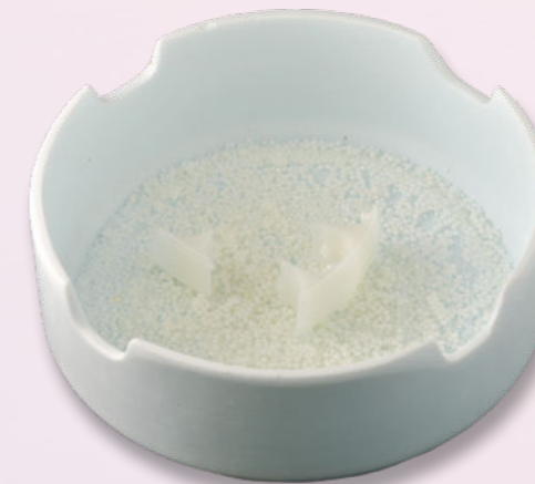
Chutes de disque de zircone à haute transparence non teintées placées dans un plateau de frittage sur les billes de frittage pour la décontamination du four.
